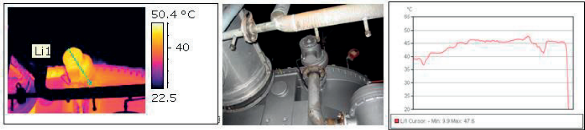
Slika 3: Termalni snimak, fotografski snimak i temperaturni profil uljne pumpe [4]
