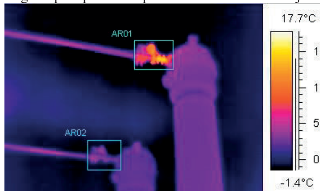
Slika 8: Termogram pola prekidača [3]
